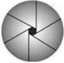
Hier ist eine kleine Blende abgebildet. Die kleine Öffnung lässt nur wenig Licht in das Innere der Kamera. Die lamellenartige Struktur der dargestellten Irisblende sorgt für eine flüssige Blendenbewegung und für eine mittige Ausrichtung der Durchlassöffnung.
