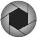
Die Blende besteht in der Regel aus 5-9 überlappenden Lamellen. Diese Abbildung zeigt ein weit geöffnete Blende. Somit dringt, bei gleicher Belichtungszeit, deutlich mehr Licht auf den Kamerasensor.
